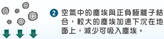
2 空氣中的塵埃與正負極離子結合，較大的塵埃加速下沉在地面上，減少可吸入塵埃。
