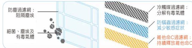
① 冷觸媒過濾網 Cold Catalyst Filter 可捕集及分解空氣中的氨氣、三甲胺、甲醛、乙硫醇等有毒氣體及異味，減少氣體達 95.5%<sup>o</sup>。
