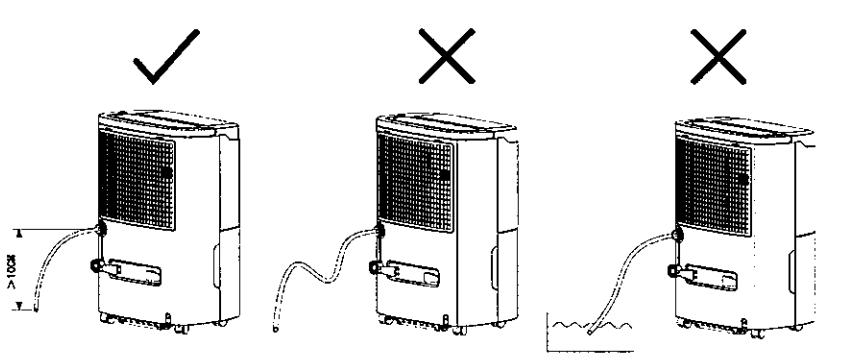
注意：外接水管不可過長（建議長度小於 0.6 米），水管末端高度須低於機身排水口高度 10 公分以上，水管要保持順暢，否則可能無法正常排水。
