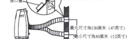
註：為確保正常使用，切勿將膠管過度伸長和彎曲。請確保排風膠管的出風口周圍（500mm範圍內）無障礙物，以便排風系統正常工作。本手冊的所有說明僅供說明用，您的空調機可能與之有細微差異，請以實際型式為準。
