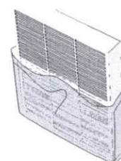
2 緊握住前面板兩側的凹槽，向外拉動面板。將門板輕輕朝上拉出。
