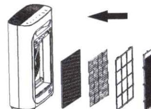
7 重新安裝前面板，對齊並插入固定的凹槽，然後輕輕將門板平推上去。
