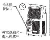
一當底盤的水位達到預定水位時,空調機組將發出8次蜂鳴聲,數字顯示區將顯示「P1」。此時空調/ 抽濕過程將立即停止。但風扇電機將繼續運行 (這很正常)。請小心將機組移至排水位置,取 下底排水塞進行排水,然後重新裝上底排水塞並 重啟空調機,直到「P1」符號消失。若再次出現 錯誤,則需要檢修。
