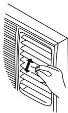
對於不帶搖擺功能的機型，水平風向調節可通過撥動垂直導風板來調整。抓住垂直導風板輕輕地向左或向右撥動即可。
