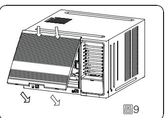
可選擇的安裝方式：電源線從面板左邊伸出
