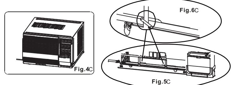
第二步 在面框處用紮帶固定電源線（只適用於機身尺寸為600x380x560的機器）
