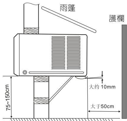
**注意：**必須用一個固定框架在下方承托冷氣機；或者用一個固定金屬挂鈎從上方吊住冷氣機。
